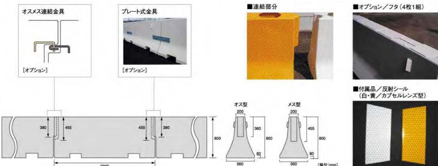
■長さ／2,000mm ■高さ／800mm ■幅(天端)／200mm ■幅(底部)／560mm ■重量(本体)／約23.5kg ■容積／約0.5m<sup>3</sup> ■材質／強化プラスチック(FRP)
