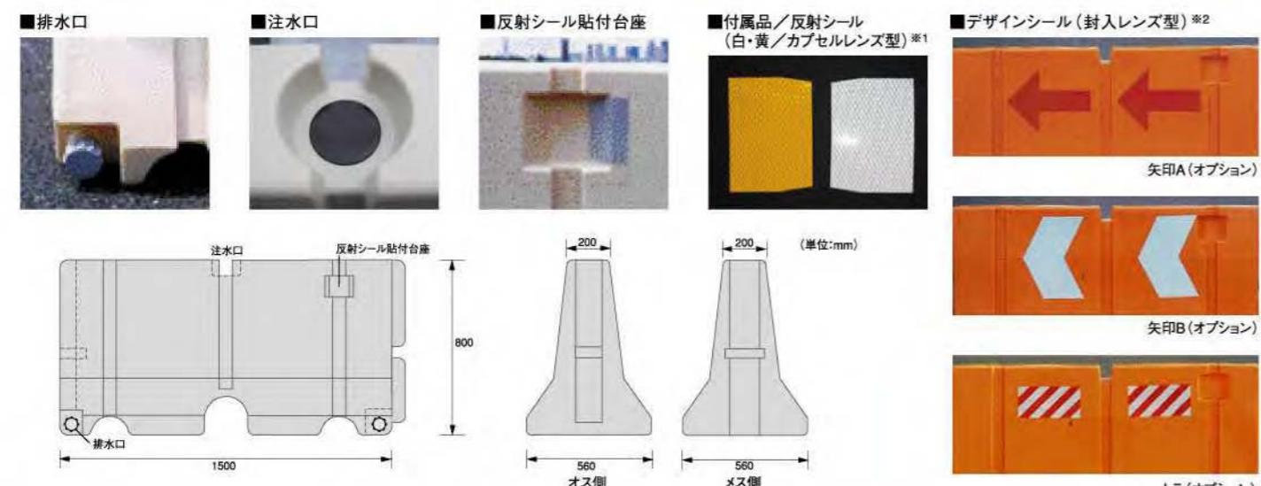
■長さ／1,500mm ■高さ／800mm ■幅(天端)／200mm ■幅(底部)／560mm ■平均肉厚／6mm ■重量(本体)／約30kg ■最大容量／約260リットル
